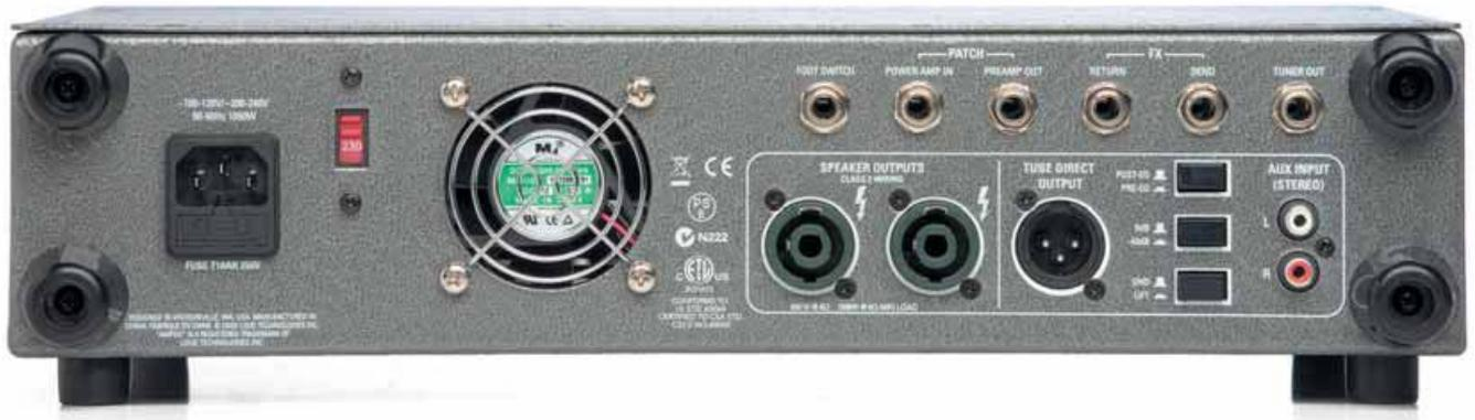
Ringkernspule, die für die verschiedenen Frequenzen passende Abgriffe besitzt. Die Phones-Buchse liegt gut erreichbar auf der Frontseite, die übrigen Anschlüsse sitzen hinten. Dort findet sich ein Tuner-Anschluss, Send und Return des Effektwegs und die Klinken für Preamp Out und Power Amp In, die man gegebenenfalls auch als zweiten Einschleifweg nutzen kann, der dann nur auf die Lautsprecherwiedergabe, aber nicht auf den symmetrischen D.I.-Output wirkt.
